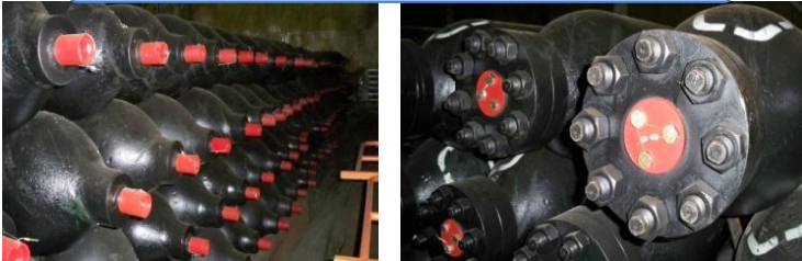
Баллоны для хранения сжатых газов объемом 500 л на давление 40 МПа системы 2Г801
